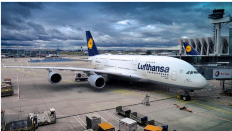
Airbus A380, das größte zivile Verkehrsflugzeug in der Geschichte der Luftfahrt: Länge 73 Meter, Flügelspannweite 80 Meter
